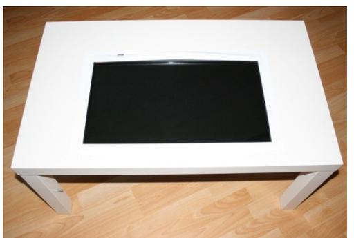
**Abbildung 25:** Erstellter Multitouch-Tisch
