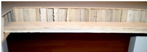
**Abbildung 22:** Aussägung mit Holzbrett für Displayhalterung
