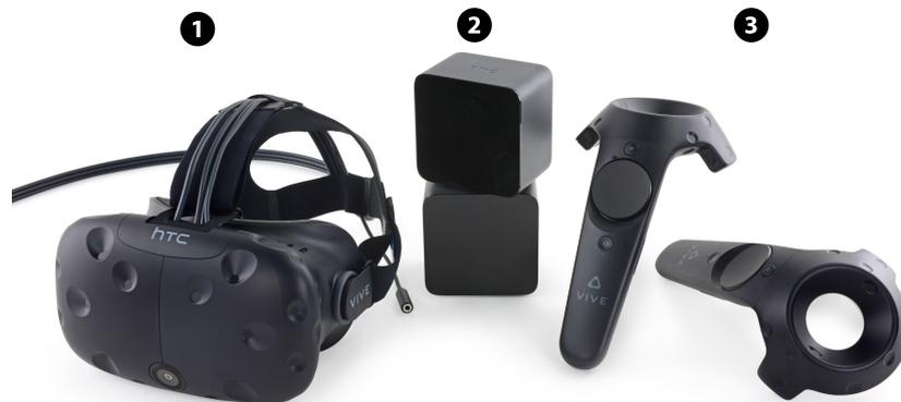
Abbildung 5.1: HTC Vive-System bestehend aus (1) HMD, (2) Basisstationen und (3) Controllern<sup>3</sup>.
